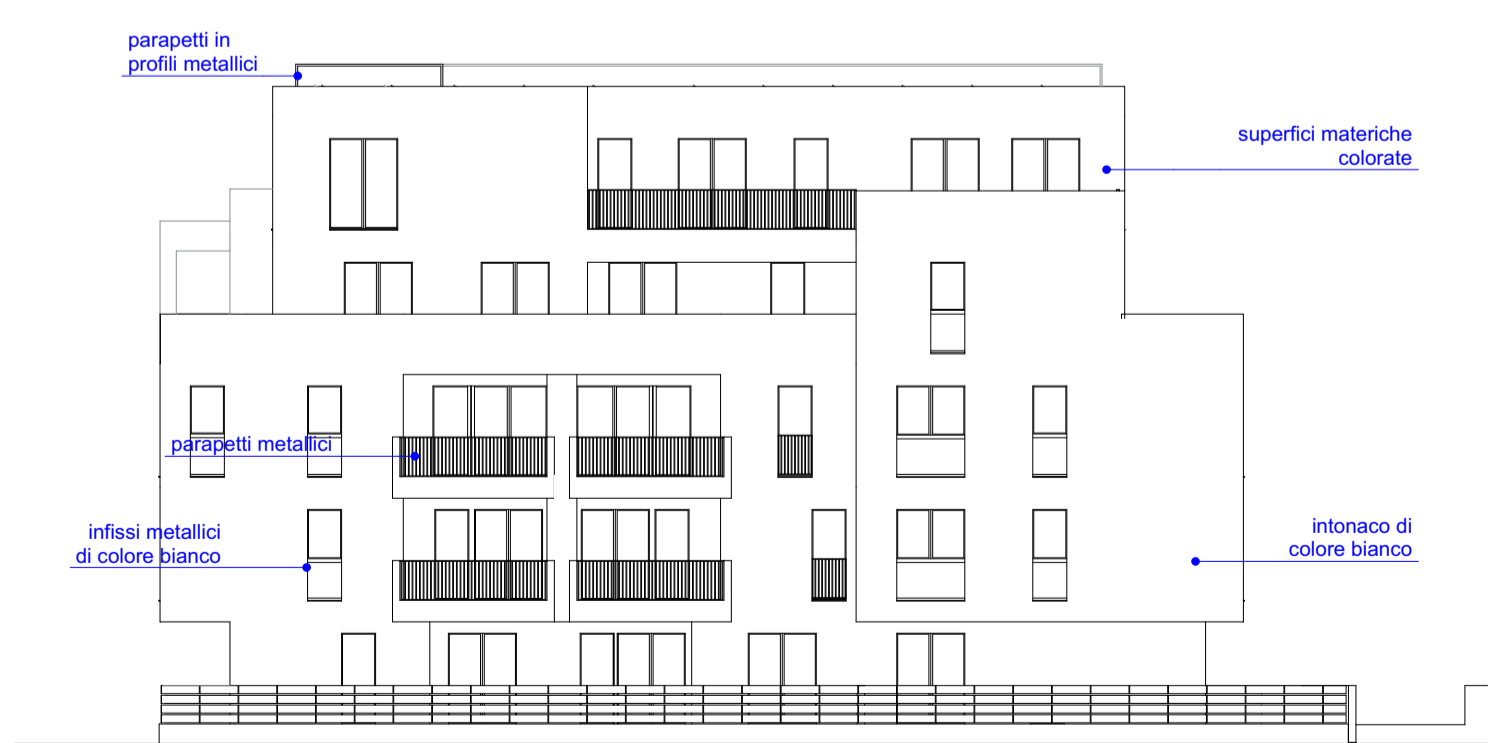
PROSPETTO OVEST EDIFICIO E
